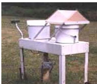
**Figura 6.2.5 Muestreador de depósito atmosférico**
