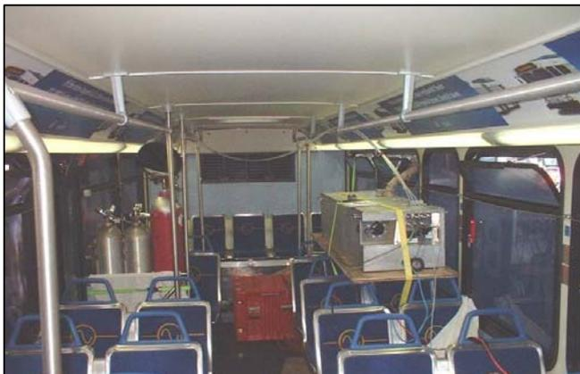
**Figura 10.2.1 Equipo de medición de emisiones vehiculares a bordo**
