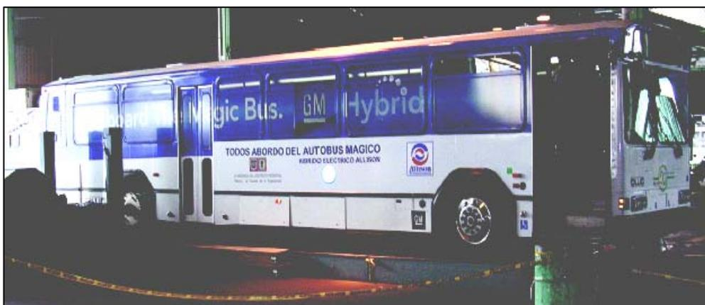
Figura 10.2.2 Autobús Allison en el dinamómetro de chasis
