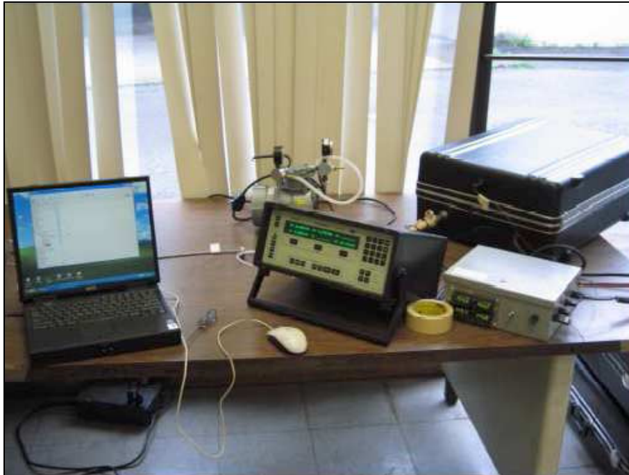
Figura 4: Analizador foto acústico Innova 1302 y el sistema de muestreo.
