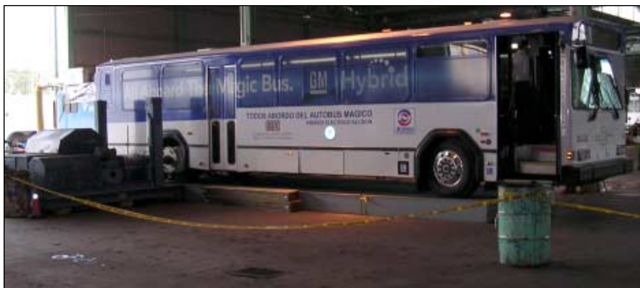
Figura 3: El laboratorio Móvil de la WVU probando el autobús híbrido-eléctrico ALLISON.
