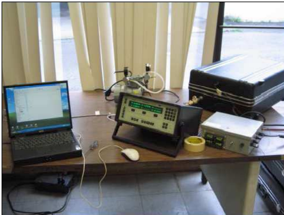
Figura 4: Analizador foto acústico Innova 1302 y el sistema de muestreo.
