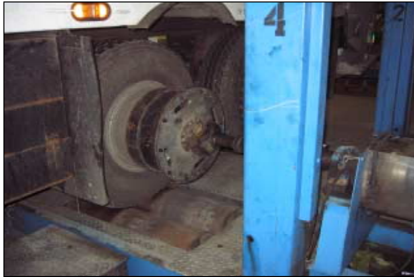
Figura 1: El adaptador de cubo conecta el eje del vehículo a la unidad de absorción de potencia.
