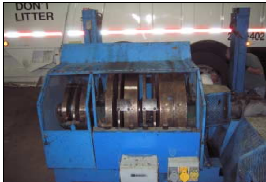
Figura 2: Las ruedas volantes se utilizaron para simular la inercia del vehículo.
